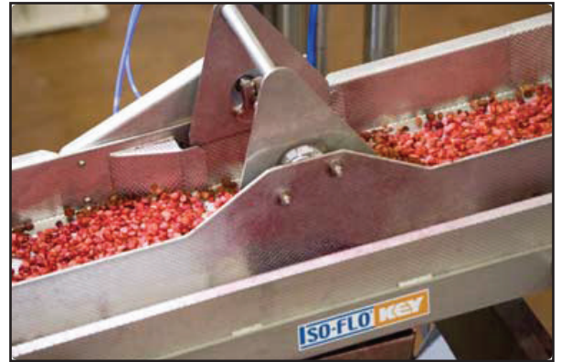
Este transportador vibratorio Iso-Flo incorpora una puerta abatible para la distribución de las pasas en proceso.
