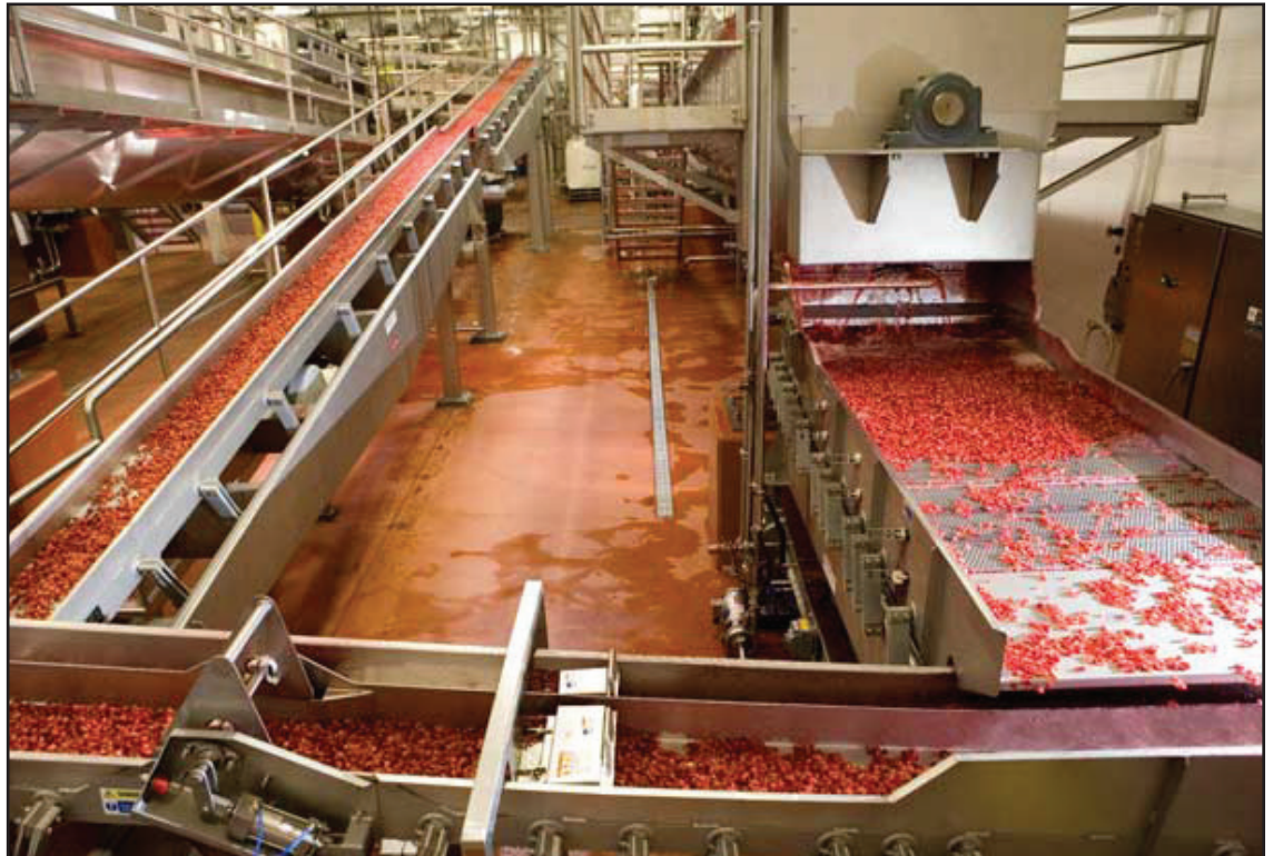
Los transportadores vibratorios Iso-Flo forman una parte integral de la línea de procesamiento sanitaria de Ocean Spray.
