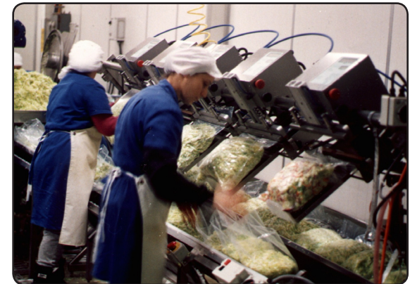
El sistema AVSealer sobre sistema flexible de soporte de piso en bastidor
